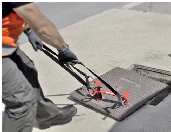
Foto 2. – Dispositivo LifterPro con eslingas abriendo una tapa.
